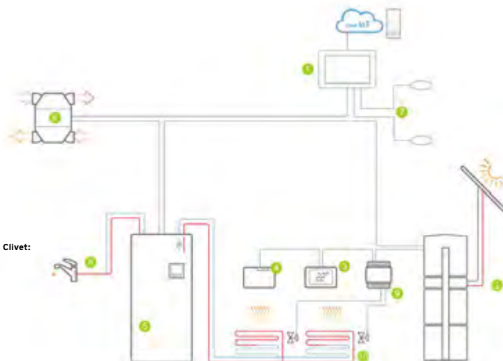
LA CENTRALE termofrigorifera è composta da apparecchi Clivet, fra cui la pompa di calore Gaia collegata a un campo geotermico e a collettori solari termici
