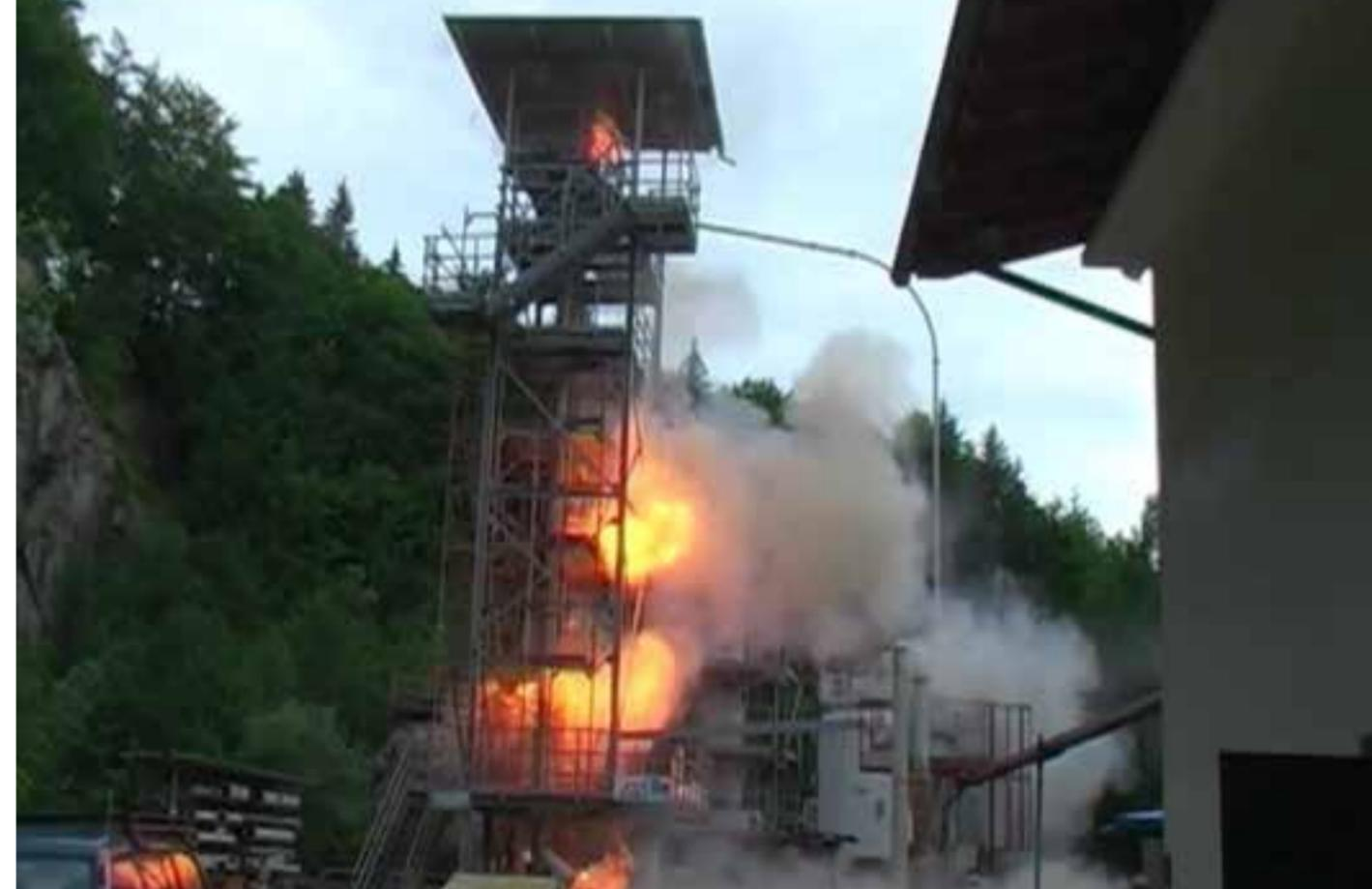
TEST DI PROPAGAZIONE DELLE ESPLOSIONI DA POLVERI CONDOTTI DA FSA (GERMANIA)
