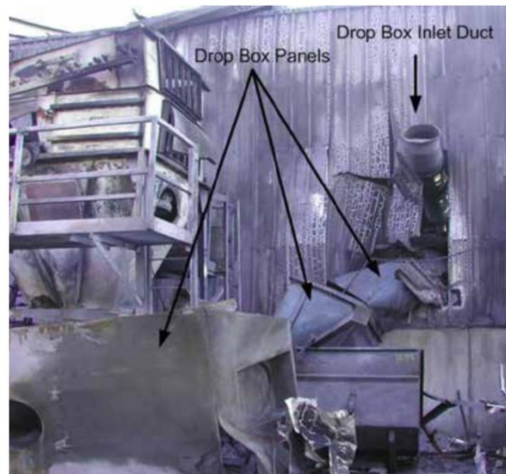
VISTA DEL FILTRO DEPOLVERATORE E DEL SISTEMA DI CARICO DOPO L'ESPLOSIONE DA POLVERI
